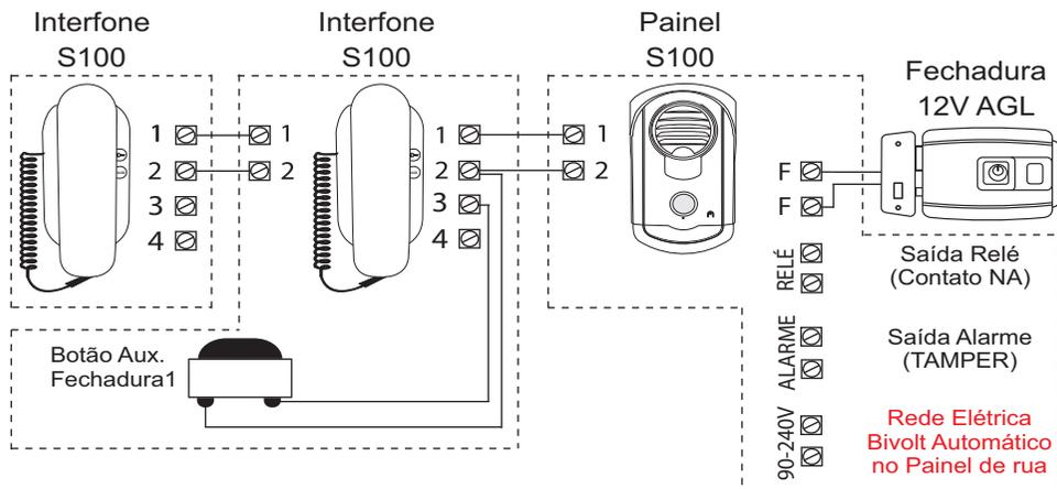
Use os **Terminais (2) e (4)** do Interfone para instalar o botão auxiliar de acionamento da **Saída Relé**.
